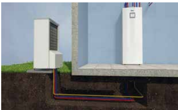
Monoenergetsko delovanje s stolpnim notranjim modulom AW M oziroma AW MS. Oba uporabljata integriran bojler za toplo vodo za kar največje udobje. AW MS je mogoče priključiti tudi na solarni sistem.
